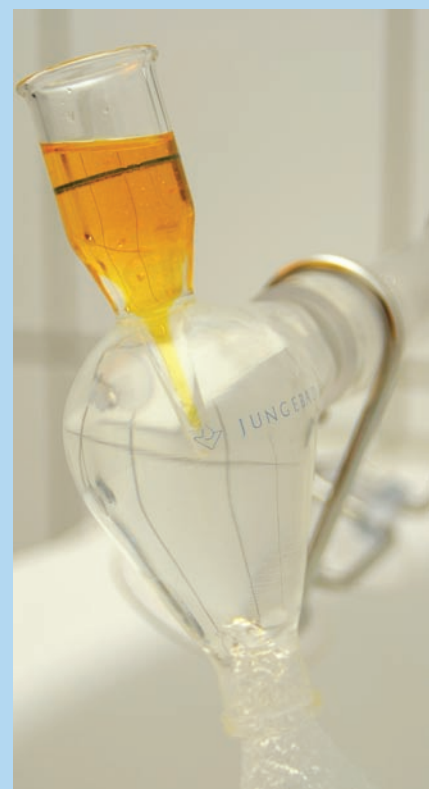
~ Jungebade-Gerät in Aktion: Gasförmiges Öl legt sich um Nebeltröpfchen.
